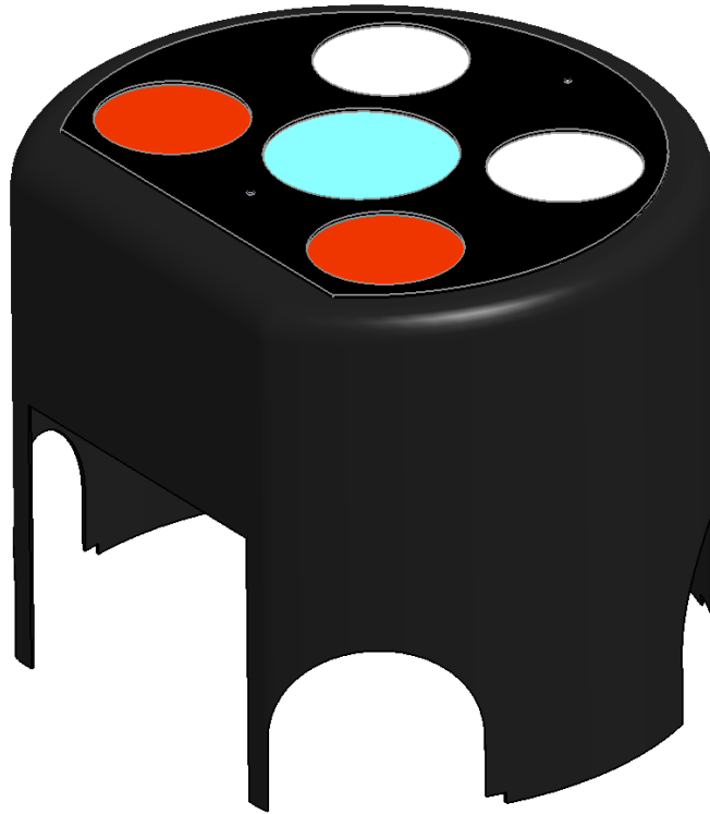
Abbildung 2.42: CAD Modell der Außenhaut des Roboters
